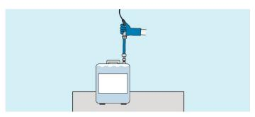
4. Conectar el producto con el sistema de dosificación a través de la caña de aspiración correspondiente.
